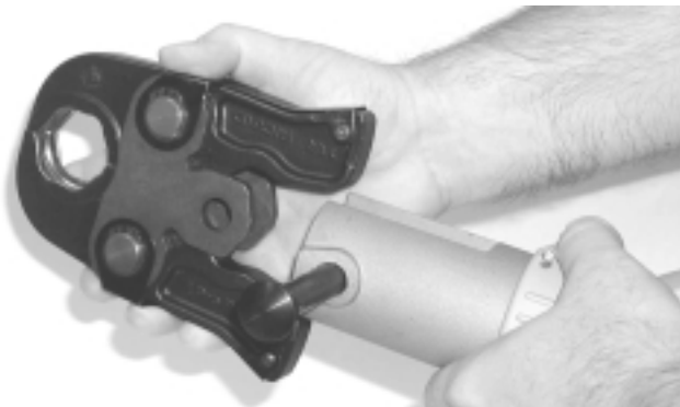
Figure 2 – Insertion du jeu de mâchoires
