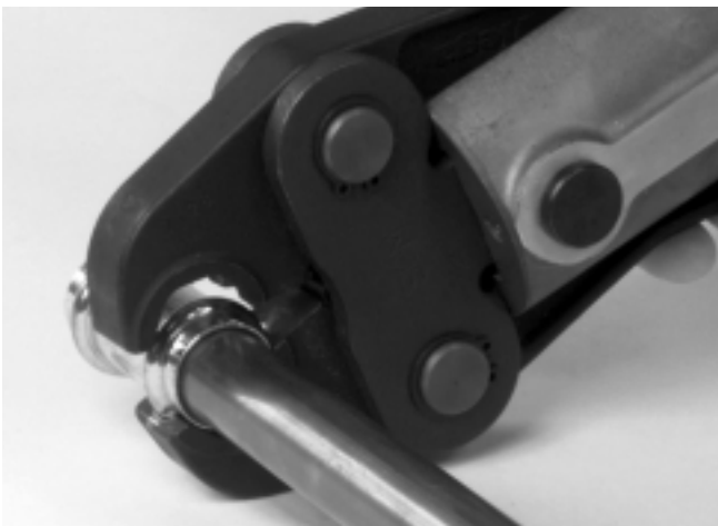
Figure 7 – Positionnement des mâchoires SHP sur le raccord
