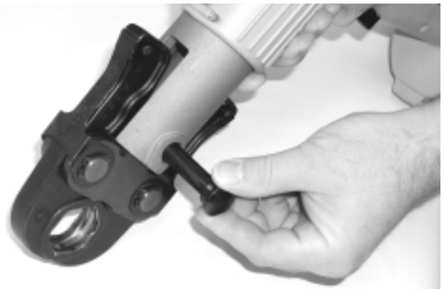
Figure 1 – Retrait de l'axe de montage du jeu de mâchoires
