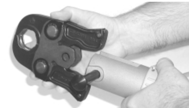
Figura 2 – Introducción del juego de mordazas en la Selladora
