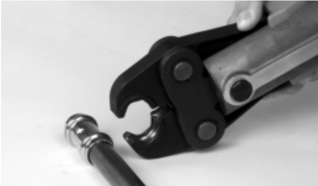
Figure 6 – Ouverture des mâchoires SHP
