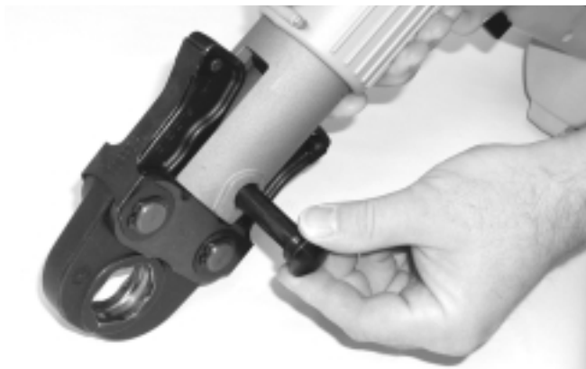
Figura 1 – Retracción del pasador para el montaje de las mordazas
