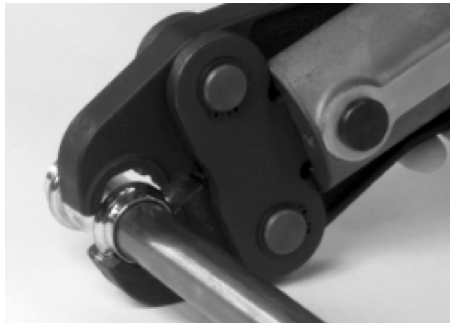
Figura 7 – Posición de las mordazas SHP alrededor del acoplamiento
